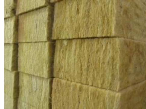
Pannelli isolanti in lana di roccia
